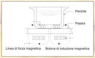
Quando la corrente ad alta frequenza passa attraverso la serpentina, si crea un campo magnetico. La forza magnetica penetra nelle molecole della pentola creando un numero infinito di movimenti che generano calore. La tecnologia di questa piastra riduce al minimo la dispersione e perdita di energia.
